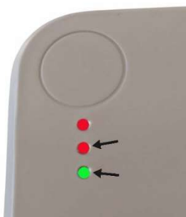
Abb. 2b: Die beiden unteren LEDs müssen gleichzeitig blinken, will man sich direkt mit der Pumpe verbinden.
