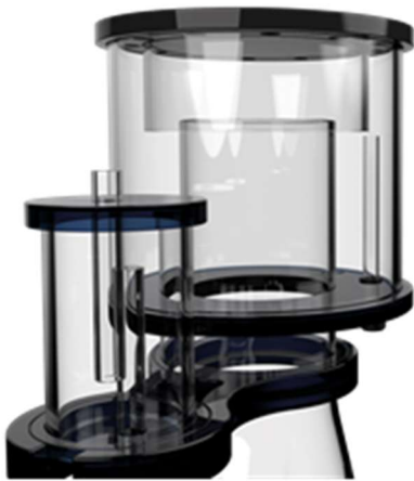
Рис. 3: В поролоновой чаше есть регулируемая по высоте переливная трубка. Оттуда вода может быть направлена в емкость рядом со скиммером. Убедитесь, что внешний контейнер не переполняется.
